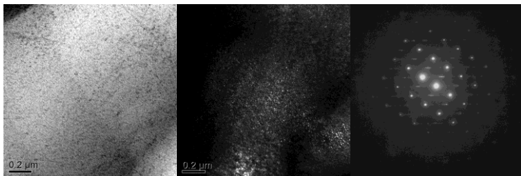
Светлое поле Темное поле Микродифракция Рис.2. Микроструктура и микродифракция сплава Mg-4,35%Sm-11,5%Tb после старения 200°C, 8 ч.
